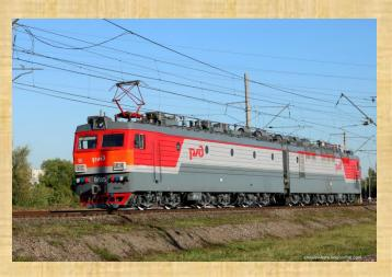
Силовая установка тепловоза включает в себя поршневой двигатель внутреннего сгорания, называемый дизелем, а электровоза — тяговые электродвигатели высокой мощности, электропитание которых осуществляется от магистральной контактной сети через токоприемник, расположенный на крыше кузова.
