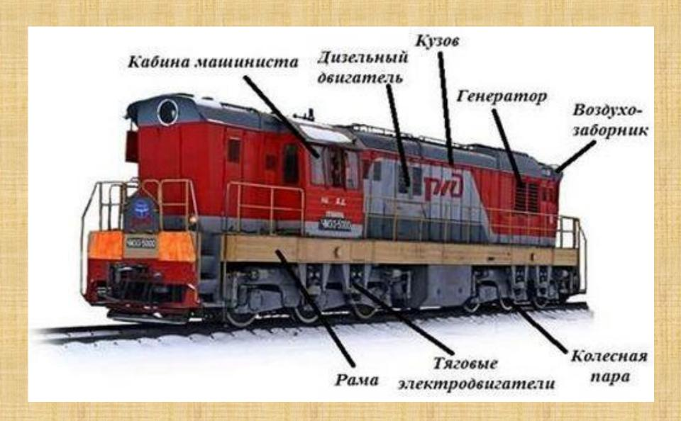
Сейчас уже не встретишь на дорогах первые машины — паровозы. Их заменили мощные тепловозы и электровозы, которые двигаются с помощью дизельного топлива и электричества. Тепловоз и электровоз — это виды локомотивов, ключевая разница между ними — в способе получения энергии.
